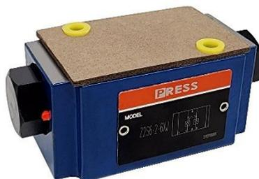
A válvula de retenção Z2DS6 é uma válvula de retenção com desbloqueio na forma de placa intermediária. Destinam-se ao bloqueio sem vazamentos de uma ou duas conexões de consumidores, mesmo em caso de longas paradas.
